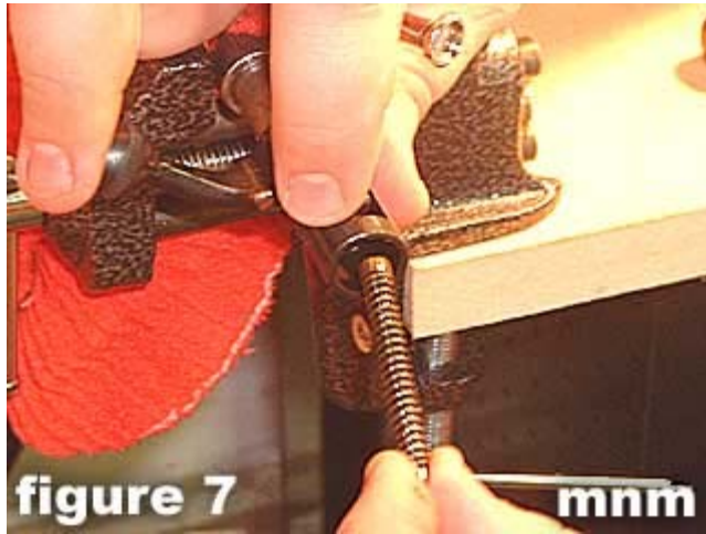
7) Remove the striker and striker spring .
